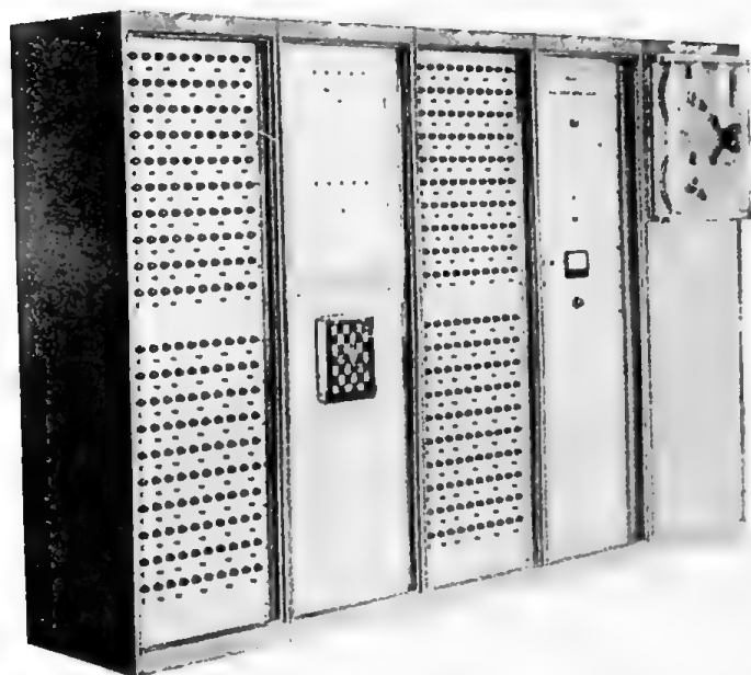
ציור 10-9. מערכת אסוף נתונים זו ב" Republic Aviation Co. מספררת את הפלט של 200 מתמרים שונים ומכינה את הנתונים הספרתיים בצורה המתאימה לקליטה במחשב ספרתי באמצעות סרט מגנטי.
